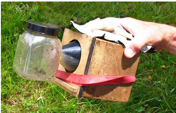
Abb. 1: Transportabler Photoelektrode zur Separation positiv phototaktischer Gliedertiere (Insekten, Spinnen etc.) aus Kescherfängen ohne systematische Präferenz.
